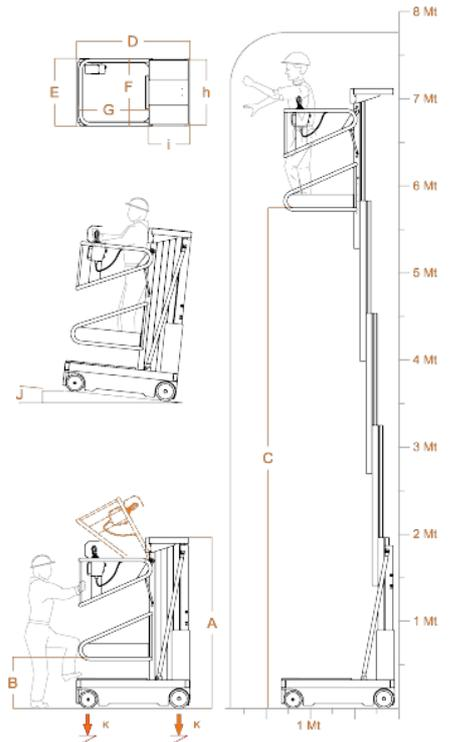
\* Pressione massima considerando che il peso della piattaforma più il carico massimo a bordo del cestello siano completamente distribuiti su un solo lato della piattaforma (carico totalmente asimmetrico).
