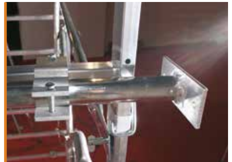
Staffa per ancoraggio a parete. Bracket for wall anchoring.
